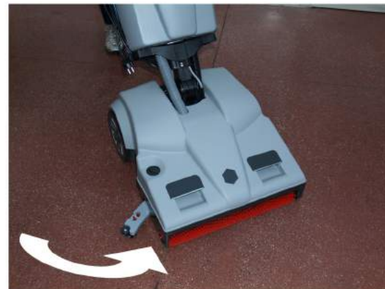
9. Kun käännyt, imusuulake kääntyy vastakkaiseen suuntaan imeäkseen kunnolla kaiken veden.
