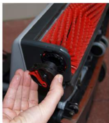
7. Vrid på cylinderborststödet och tryck upp cylinderborsten mot stödet. Ta bort stödet. Sätt tillbaka cylinderborsten i borsthuset och dra ut den underifrån för att rengöra bashuset eller för att byta cylinderborst.
