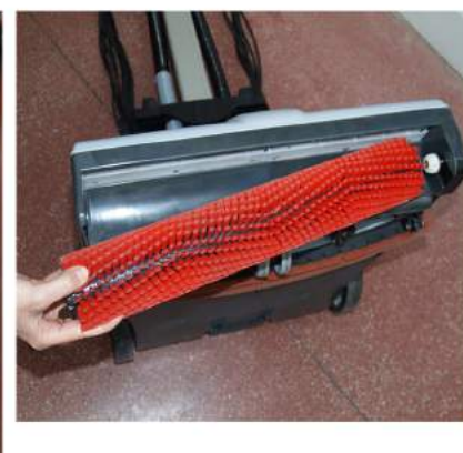
7. Vrid på cylinderborststödet och tryck upp cylinderborsten mot stödet. Ta bort stödet. Sätt tillbaka cylinderborsten i borsthuset och dra ut den underifrån för att rengöra bashuset eller för att byta cylinderborst.
