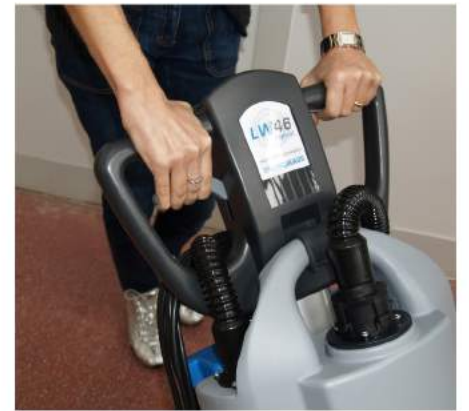
5. Vapauta varren lukitus ja aseta ohjauksyksikkö haluttuun työskentelykorkeuteen.
