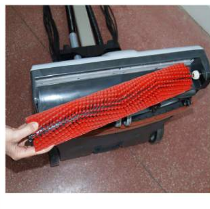
7. Sylinteriharjan lukituksen avaaminen: Aseta kone selälleen. Käännä koneen oikeassa reunassa olevaa harjan lukitsinta ja työnnä sylinteriharjalla lukitsin ulospäin. Vedä lukitsin pois. Irrota harja kääntämällä sitä koneesta pois päin ja vetämällä. Harja kiinnitetään paikalleen toistamalla työvaiheet toisinpäin.
